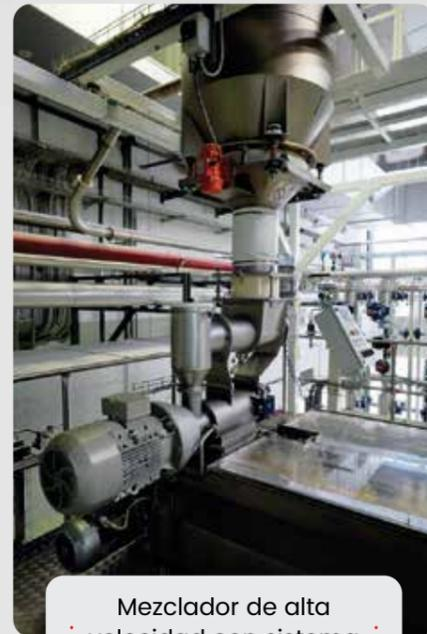
• Mezclador de alta velocidad con sistema de dosificación •
