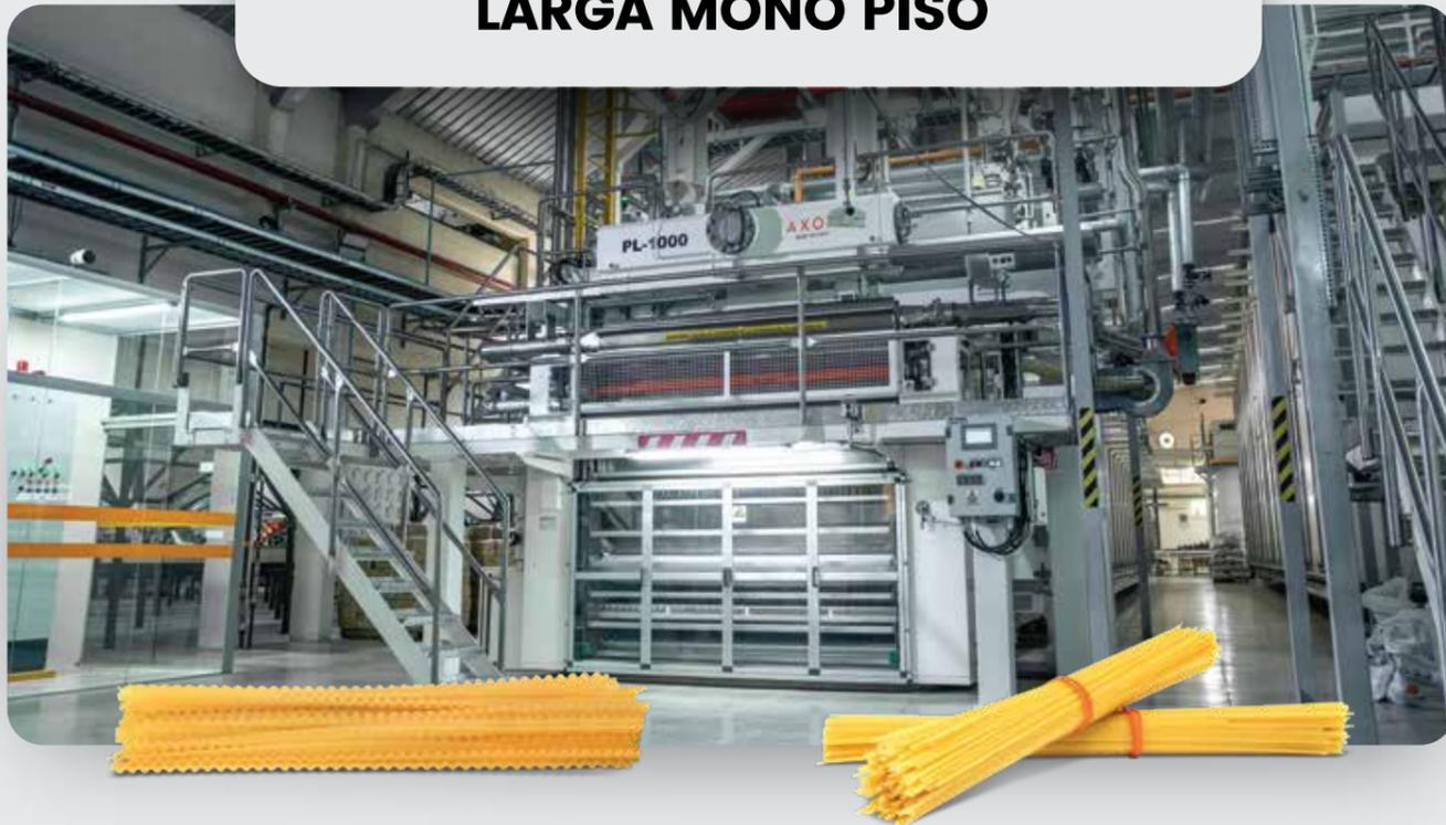
Las Líneas para Pasta Larga Mono Piso AXOR, con una capacidad a la salida que va de 1000 kg/h a 1500 kg/h, representan el equilibrio perfecto entre tecnología, simplicidad y ahorro de costos de producción/mantenimiento. La prensa T.V.S. (Sistema de Vacío Total) y el uso de altas temperaturas permiten alcanzar una excelente calidad de pasta independientemente de la calidad de las materias primas.
