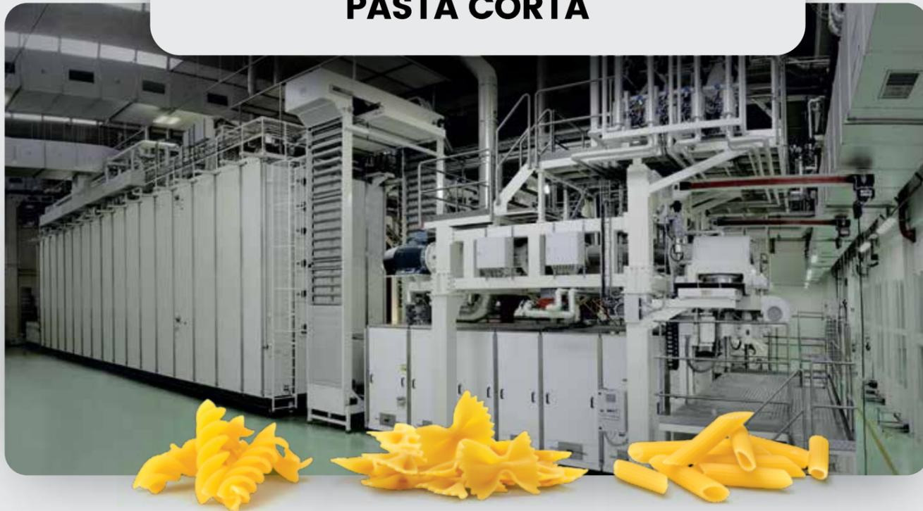
Las Líneas para Pasta Corta AXOR, con una capacidad a la salida que va de 700 Kg/h a 6000 Kg/h, permiten el uso de cualquier tipo de materias primas: gracias a la prensa al vacío, la nueva generación de trabatto con ahorro de energía (patentada) y los secaderos de alta temperatura, es posible producir una excelente pasta aun partiendo de harinas de trigo blando.
