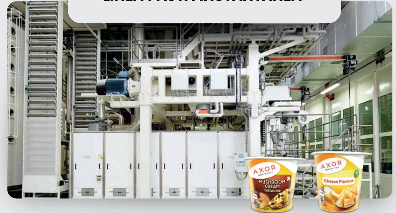
Las Líneas para Pasta Instantanea AXOR, con una capacidad a la salida que va de 700 kg/h a 1500 kg/h, combinan la tradición de la pasta con un nuevo método para prepararlas de forma natural y saludable. Gracias a una extrusión a baja velocidad, un sistema de cocción con presión de vapor minuciosamente controlada y secado homogéneo, es posible obtener un producto que no necesita ser cocinado, sino que solo necesita una simple rehidratación por aproximadamente 2-3 minutos.
