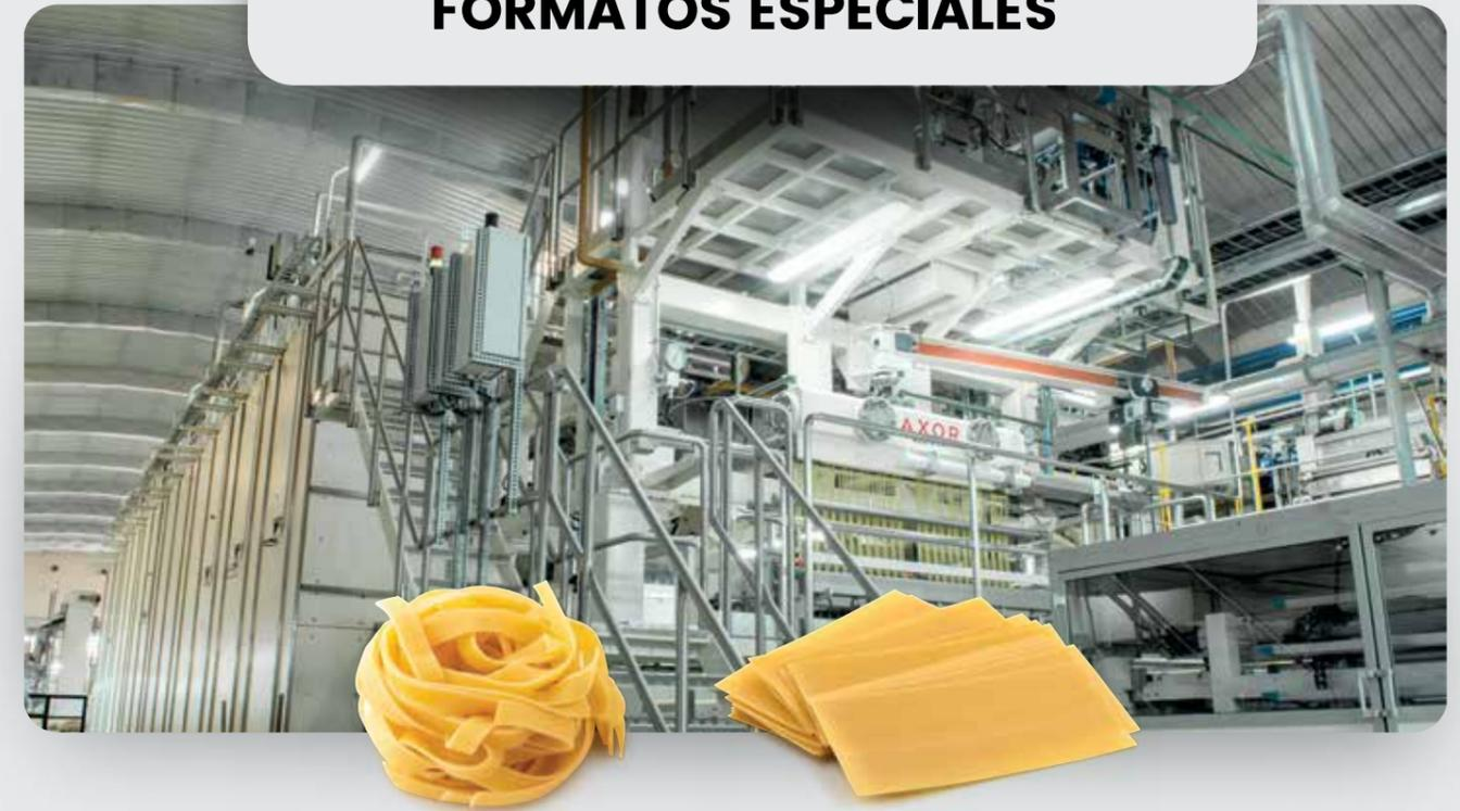
Las Líneas para Pasta Formatos Especiales tienen una capacidad a la salida que va de 500 kg/h a 1200 kg/h y describen el concepto de flexibilidad potenciado a su más alto nivel. La combinación entre la prensa T.V.S. (Sistema de Vacío Total) y el movimiento de la pasta sobre las bandejas permite la producción de cualquier tipo de pasta de formato especial: nidos redondos, nidos ovalados, lasagna, matasse, formatos de gran tamaño, canelones, farfalle, etc., sin riesgo de romper o dañar la pasta.
